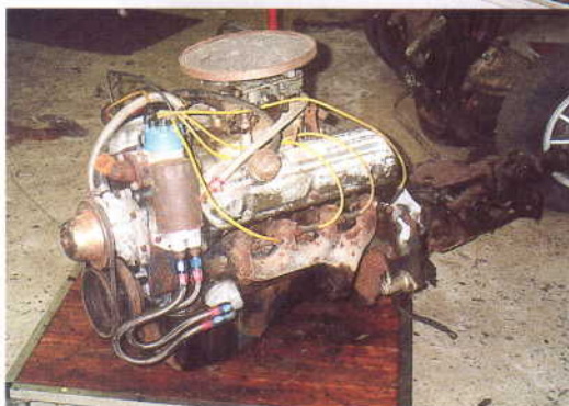
Sunbeam'ens Ford V8 motor stammer fra Mustang.
