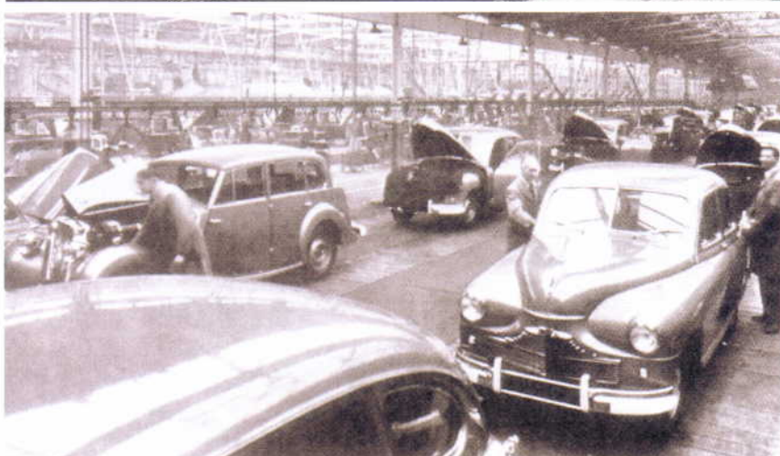
Bilbygning »the Standard way«. 8-mandshold introduceret i 1931 af Black samlede vognene af dele, der tilfældigvis var i kassen den dag. Derfor er vognene aldrig ens. Øverst Vanguard og Mayflower i tilfældig orden mellem hinanden. Nederst Triumph Renown og Vanguard mellem hinanden. Renown, smittet med tidens »knife-edge« mode for blandt andet karrosserier til Rolls-Royce, er bygget på en variant af Vanguard chassiset og med samme motor og transmission. Det samme gjaldt TR2 og den lille Standard 8.
