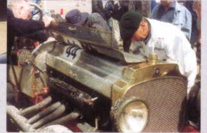
Briten David Biggins' 1913/18 Vauxhall Special Viper med Hispano Suiza V8 flyvemaskinemotor på 11.778 cc. Ingen forhjulsbremser.
