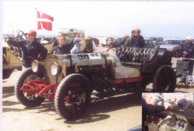
Briten David Biggins' 1913/18 Vauxhall Special Viper med Hispano Suiza V8 flyvemaskinemotor på 11.778 cc. Ingen forhjulsbremser.
