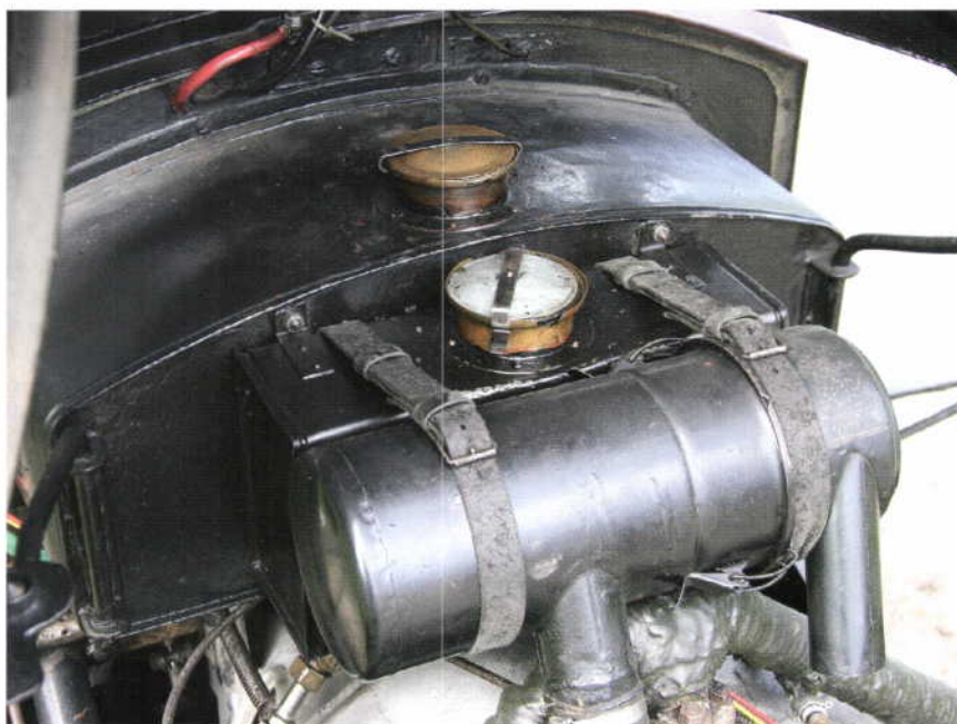
Et blik under hjelm: benzintank bagest, i midten olietank og forrest luftfilter.
