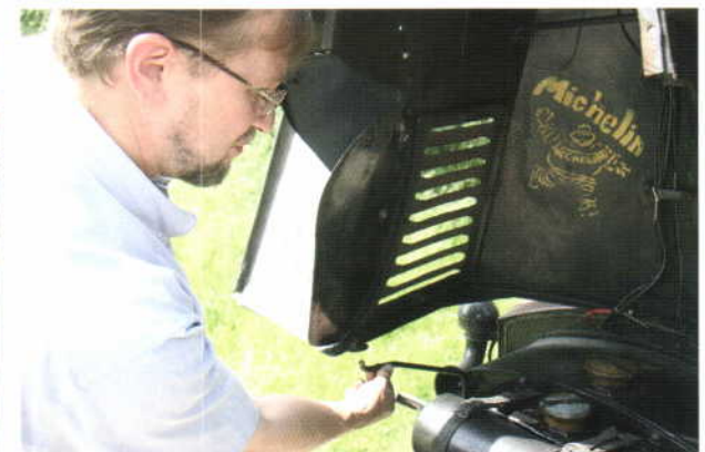
Fronthjelmen holdes oppe af to stivere, der er hængslet på benzintanken.
