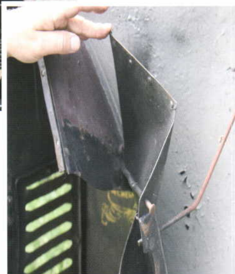
Små luftklapper til regulering af kølingen kan åbnes og lukkes alt efter temperatur og årstid.
