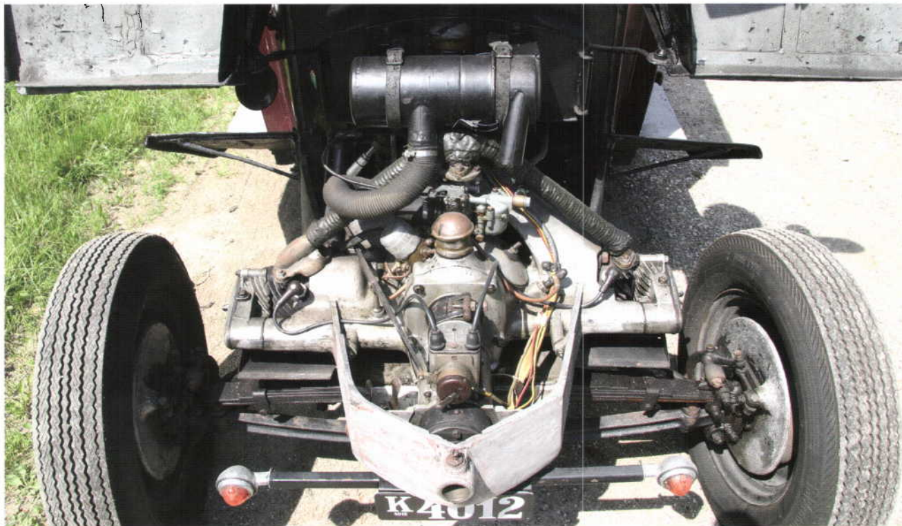
Karburator, tændrør, magnet – alt sidder lige for. Bemærk det runde dæksel (under karburatoren), der giver fin adgang til krumtapmekanismen – der er ét i den anden side også.
