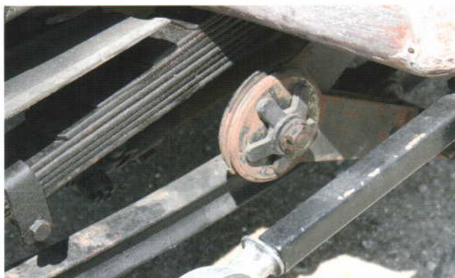
Den enlige friktionsdæmper holder styr på forakslens svingninger.
