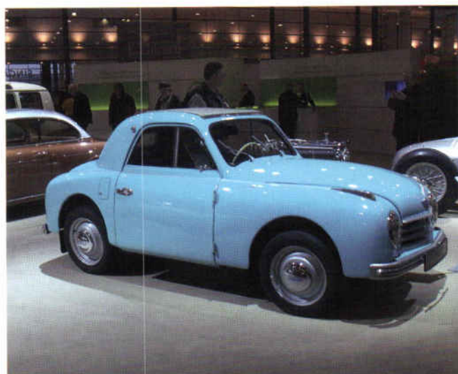
Gutbrodt 1951, en småbil med interessant teknik, nemlig totaktsmotor med direkte indsprøjtning. Konstruktøren var den senere så berømte Mercedes-chefkonstruktør Hans Scherenberg.
