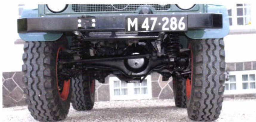
Et kig set forfra under maven på Unimog'en; her er der nok at tage vare på: razeppede på forakslens drivaksler, navreduktion, skruefjedre med teleskopstøddæmpere og en lørdag formiddag til komplet sporing og kontrol. Den sorte hætte over nummerpladen er et kraftudtag til drift af frontmonterede redskaber, såsom gadekoste, wirespil mm.
