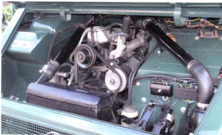
Motorrytmet, pladsen er meget kneben og motoren er nærmest lempet ned med et skohorn, men en kappe kan dog fjernes inde i førerhuset for tilsyn med motoren. Udstødsmanifolden sidder på højre side lige ved passagerernes fødder og svider deres sokker!
