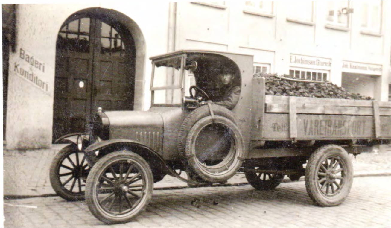
Ford TT, firmaets første bil i 1924. Bemærk åbent førerhus med fastspændingsanordning for blafrevinduer, bagdæk med større volumen end forlækkene og så reservefælgene, en til for og en til bag. Peter Rasmussen sidder ved rattet.
