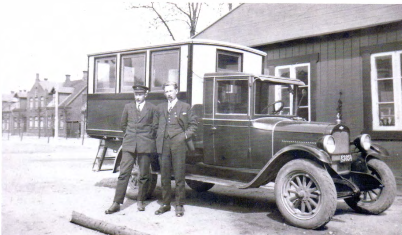
Chevrolet 1928, foto skal være fra Fredericia 29/4 1928. Begge brødre står foran den nye Chevrolet lastvogn, hvorpå der åbenbart kan monteres en kasse beregnet for persontransport.
