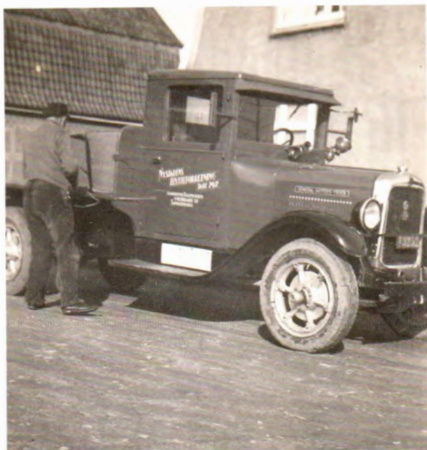
Sammen med Æ 3099 fandtes en General Motors Truck med nr. Æ 3252. Den er ret typisk med sine forhjulstrømter, der meget ligner GMC'ens i VT 360 juni 2006 side 37. På det ene foto ses de to lastvogne sammen med en hyrevogn af mærket Adler, en tilsyneladende ret massiv bil.
