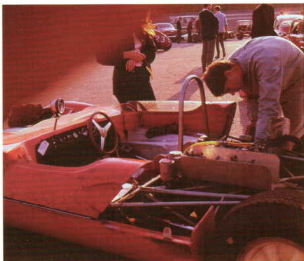
Til Ringens finale er Ole ved at klargøre sin orange Lotus 23. Bemærk den superlette konstruktion med den kleine ramme og spinkle styrtøjle. (Vejlund).
