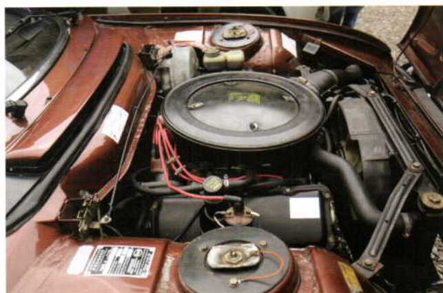
Peugeot 504 V6 1977, ejet af Jan Christensen. V6-motoren i 504 cabriolet. Motoren blev også anvendt i Renault 30 og Volvo 164/264.
