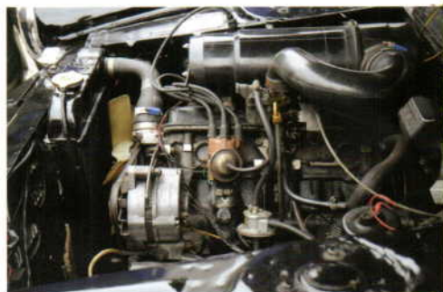
Peugeot 404 1969, ejet af Søren Lund. Motoren i 404 hælder, for at give en lavere front.
