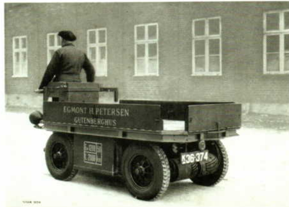
Titan Elektrokærre til 2 Tons Last udført med Luftringe
