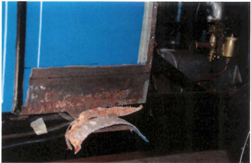
Det blev nødvendigt at reparere et rustangreb på højre forreste hjørne af karrosseriet. Der er tilbage i tiden lagt en glasfibermatte hen over rusten. Karrosseripladen, der er 0,65 mm. tyk, blev udskiftet fra den sorte streg og ned.
