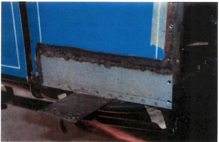
Den rustangrebne pladedel er her udskiftet. Til at fastgøre den nye torpedo, brugte jeg små undersænkede skruer. Skruer holder bedre fast i træet end søm.
