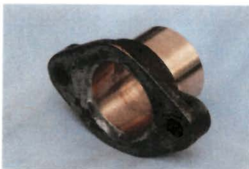
Den komplette vandstuds efter reparation.
