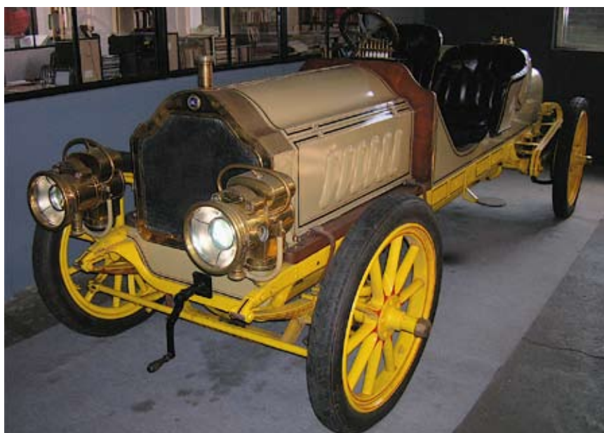
Delaugère & Clayette 4A 1904 har tidligere stået på Ålholm, hvor den fik det nuværende karrosseri. 4 cylindret på 6.2 liter, 45 hk. Lavspændings afbrivningstænding. Dobbelt kædetræk.
