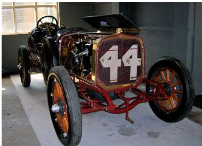
Corbin 1910. Denne eller en tilsvarende deltog i Vanderbilt Cup 1. oktober 1910, hvor Corbin måtte udgå pga. en utæt pakning i kølersystemet. Løbet blev kørt på Long Island og var på 22 omgange à 12,540 miles – i alt 447½ km. Motoren er på 12.7 liter med 4 cylindre i to blokke.
