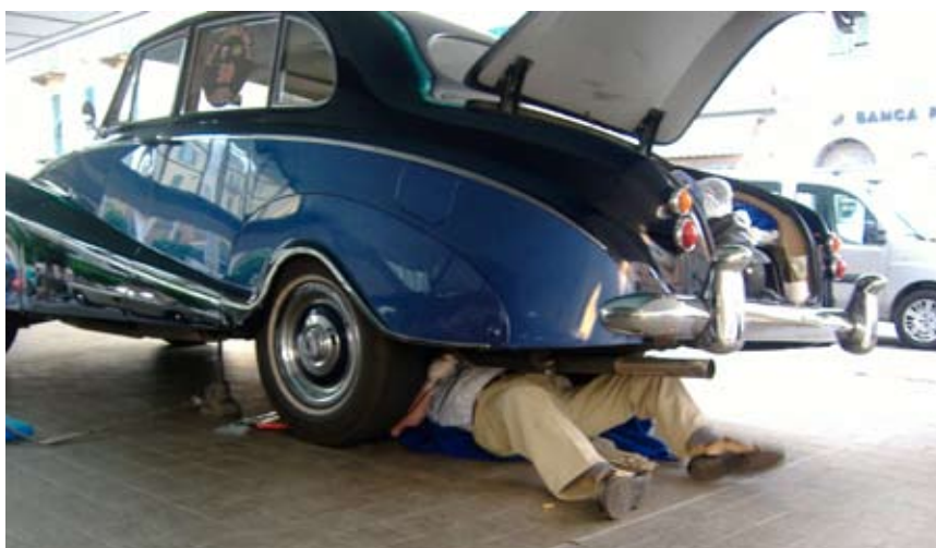
Reparation af knækket udstødning.
