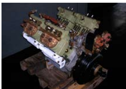
Den uidentificerede V8 motor. Bemærk de to magneter.
