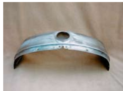
Bagstykke isvejst og grovslebet.
