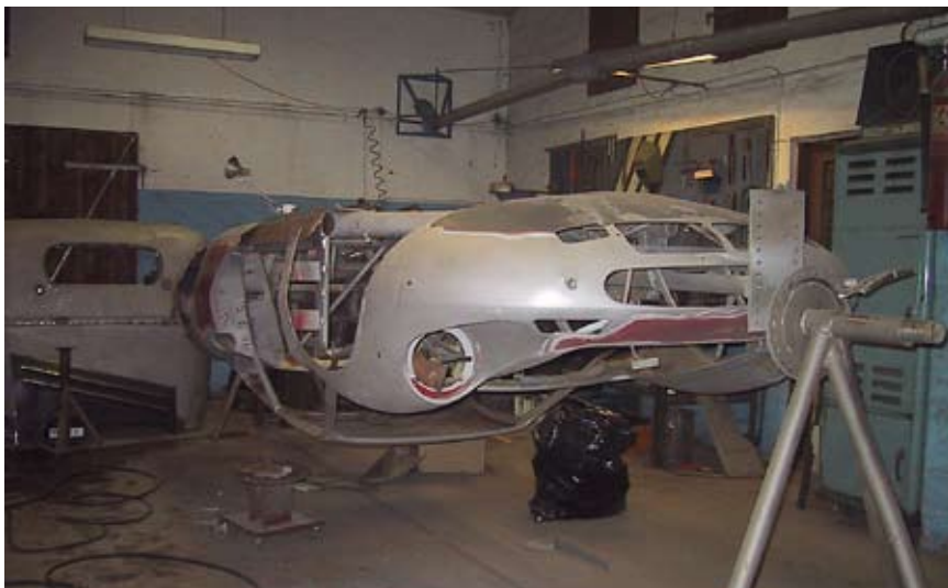
Opsætning a la Stefano Boes, hvor hele karrosseriet kan drejes rundt til perfekt arbejdsposition.
