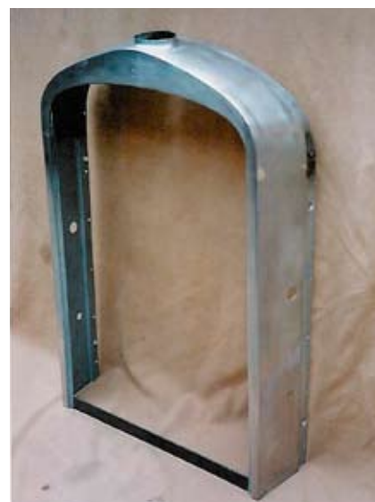
Den sammensvejste kølerkappe grovslebet og klar til finslibning og polering.
