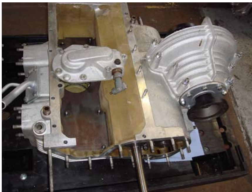
Motoren monteres på dette transmissionshus med gearkassen indbygget i sin egen halvdel med spærredifferentialen oven på.
