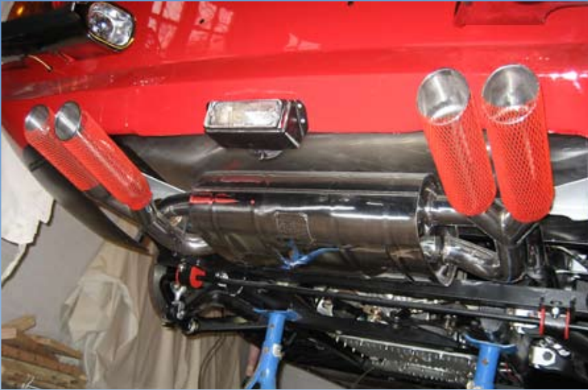
Rustfri udstødning med særlig dæmpende indvendig coating så den typiske metalliske lyd elimineres. Systemet passede ikke, så det måtte en tur retur til Maranello sammen med det oprindelige system og blev modificeret i en rig til perfekt pasform.
