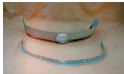
Bagstykke inden sammensvejsning med topdel.
