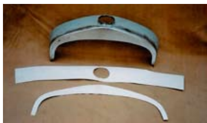
Papmodeller til fremstilling af pladestykker.
