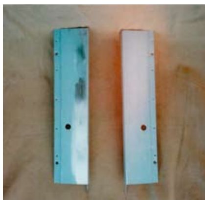
Sidestykker klar til sammensvejsning med overdel.
