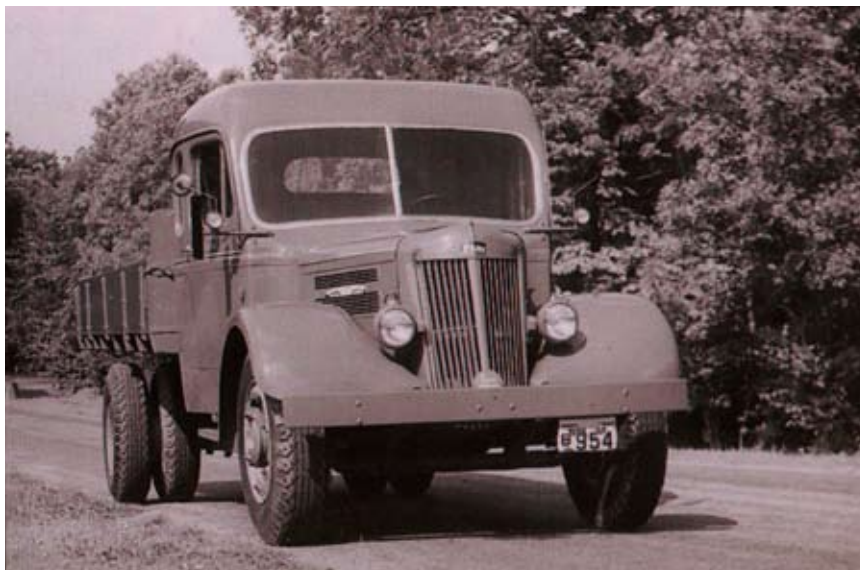
Her er så bedstefars White 1946 endnu på prøveplader. Den havde en Bur-Wain motor på 110 hk og den havde overgear. Med to køjepladser var den perfekt til langturkørsel, og bedstefar opnåede hurtigt tilladelse til Europakørsel. At køre gennem det sønderbombede Tyskland må have været sælsomt.
