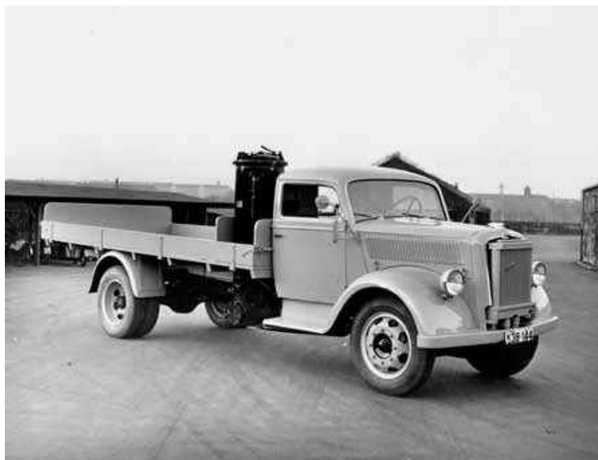
En nyere Blitz demobil (1943) med generator og originalt førerhus
