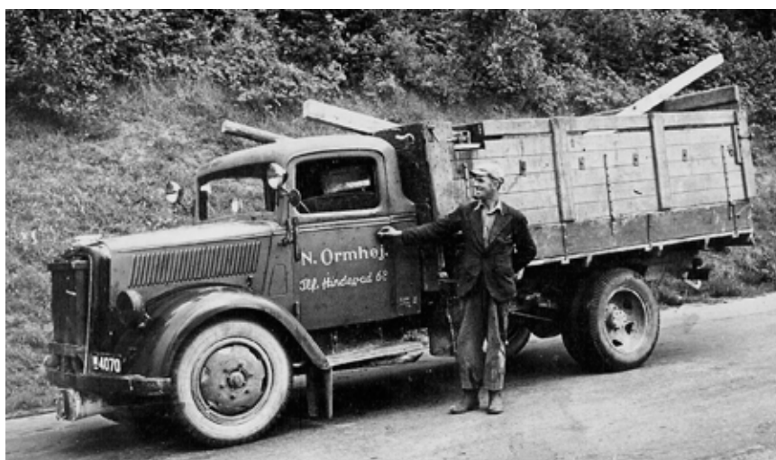
En typisk Vognmands-Blitz 3,5. De højt monterede, ikke mørklagte ekstra-lygter kunne tyde på, at bilen også blev brugt til kørsel med sneplov.
