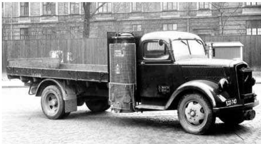
Opel Blitz 3,6 med Imbert generator. Trods generatoren er tilladte nyttelast stadig 3.700 kg.
