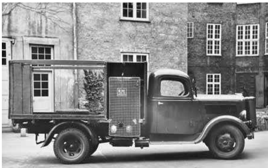
Opel Blitz 2,5 med Bur-Wain generatoranlæg.
