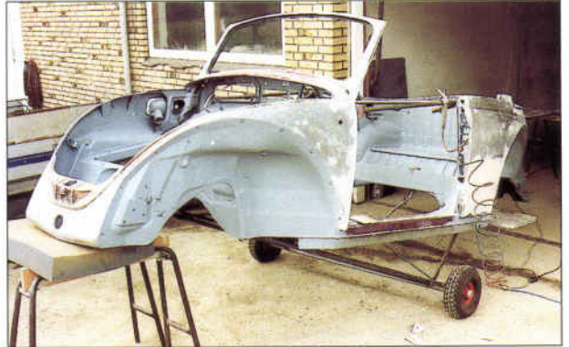
Karosseriet monteres på en lille vogn - dette letter transporten og giver god adgang til undersiden når der som her skal grundmales.
