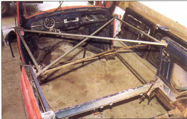
Specielt ved cabrioletér er det vigtigt med en god afstivning, inden der skæres i karosseriet. Her er stativet fikseret i hængselbeslag og beslag til sikkerhedsseler bag.
