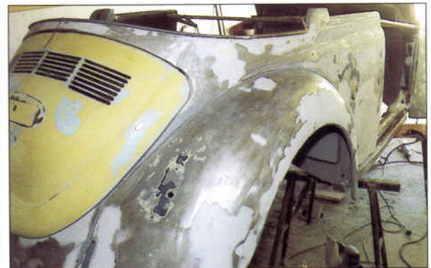
Karosseri og skærme blev befriet for mange lag mystisk lak med en varmpistol, og derefter sletet i bund, inden behandling med grunder m.v.
