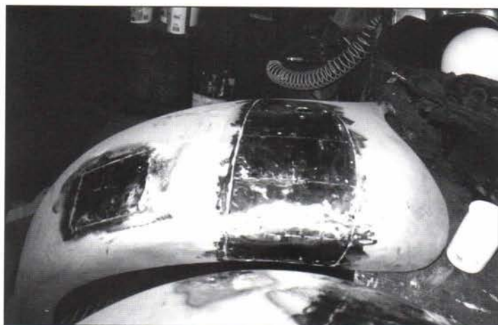
Forskærme efter isvejsning af nye pladestykker.
