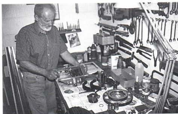
Tv. Her viser Iver Jensen at det er nødvendigt at afmontere bagtøjet for at få gearkassen ud.
