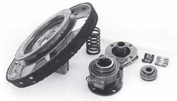
Tv. Gearkassen adskilt. Bemærk de nye bøsninger.
