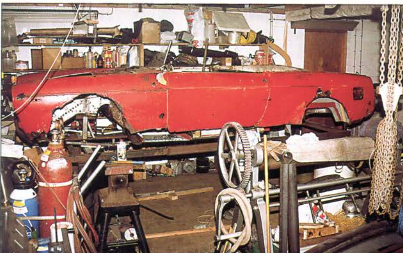
Spyder nr. 2 på bedding. Kun der øverste del af karrossen kan bevares, de fleste ville have opgivet bilen. F.eks. udskiftes hele bagpanelet med en nyfremstillet del, dannet af ophamrede pladestykker samlet ved gasvejsning til et komplet panel. Og undervejs må der fremstilles hjælpeværktøj og fixturer.
