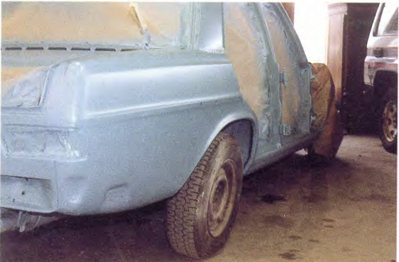
Første lag lak. (Bemærk det fine spartelarbejde!).
