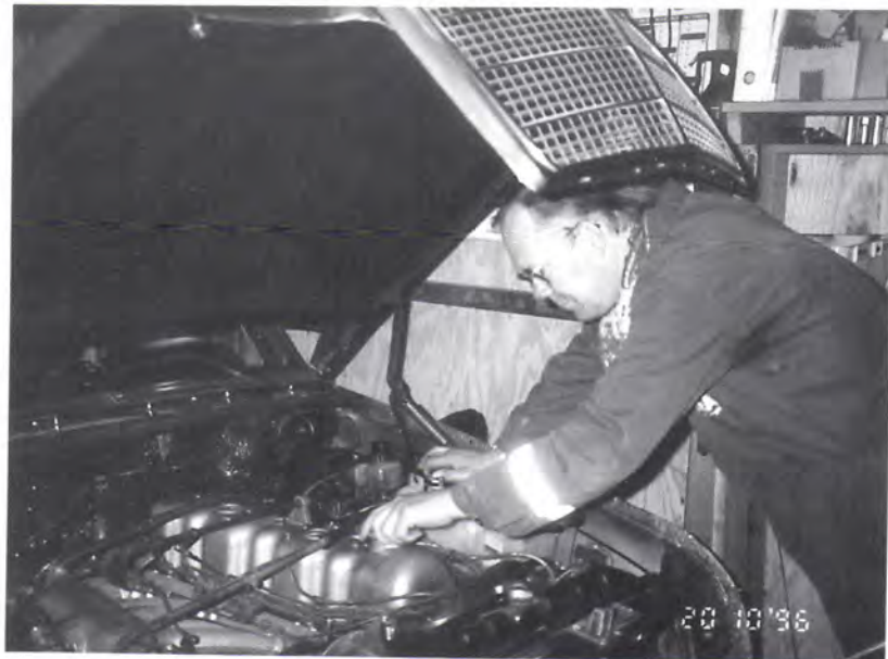
Motorrum renoveret og motor (samt ny frontramme med køler/oliekøler) monteret.
