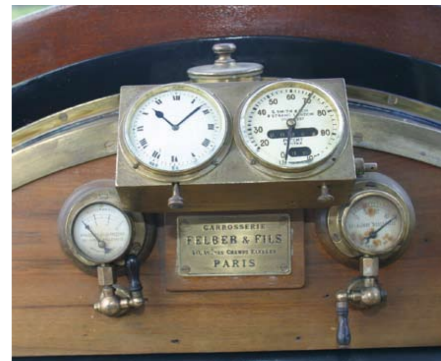
De små instrumenter står der Delaunay Belleville i – de måler olietrykket. Ovenover en kasse med et og et speedometer af mærket S. Smith & Son, Strand, London. Det går op til 100 km/t, og der er både kilometertæller og triptæller, så det må næsten formodes at være senere tilføjelser.
