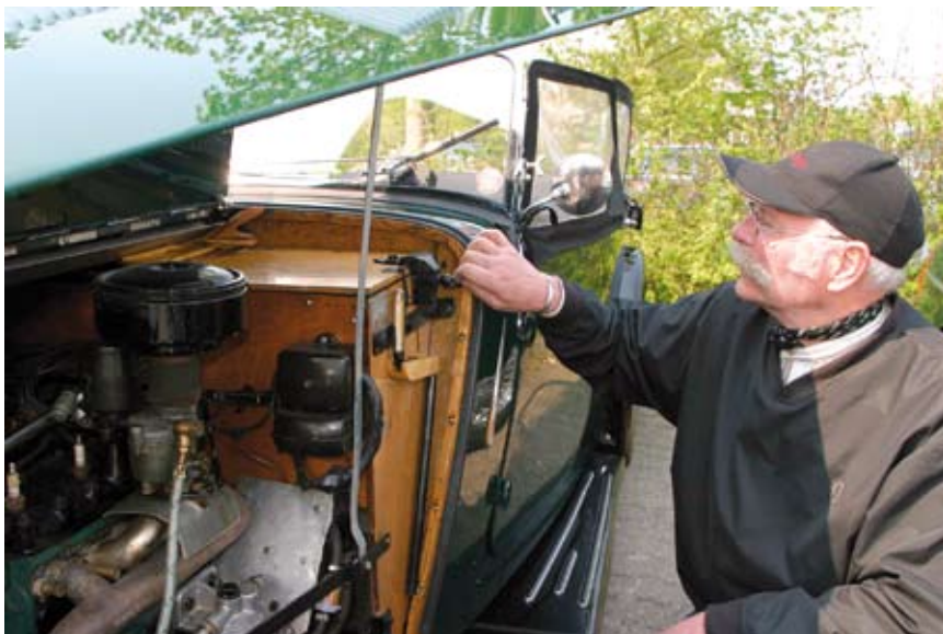
Skruestik i motorrummet. Lars Hugo Kristiansens BSA fra 1939 har en særdeles veludstyret værkstedskasse standardmonteret.
