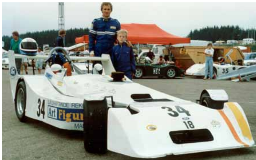
Den første ægte racer vises her frem på Ring Knutstorp af far & søn midt i den gamle pit. En Mallock U2 mrk. 21 clubracer fra 1980 er lige overtaget fra svensk kører i juli 1988. En asymmetrisk ensædet racer med Ford Kent motor på 135 HK og slicks fra F3 udgør en bombe på 460 kg. (Marianne)
