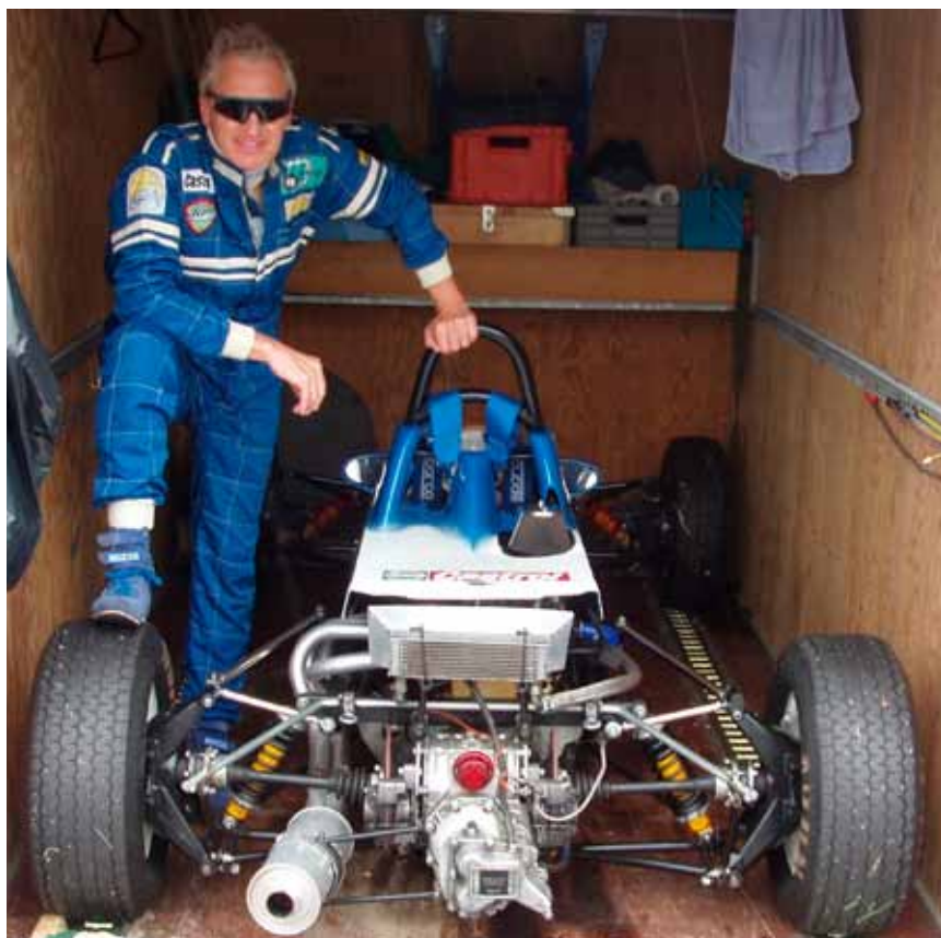
Racing byder sjældent på meget luksus som vor trange indkvartering i trailer med Van Die-men RF80 FF klart viser i 2012, men så er man da i tørvejrs så længe. Lampen på Hewland gearkassen er ikke et bremselys men en fugtig-føre-lygte (Casper)
