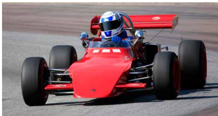
Her holder den nymalede Brabham klar til race med sine friske Dunlop Racing i 10" & 12" brede, mens den markante lodrette Weber karburator med et let filter troner bag mit hoved. Forrest på næsen den japanske kørers oprindelige logo – en fiskehejre. Bagved holder min gamle danske Corami FF i 2001 (Marianne)
