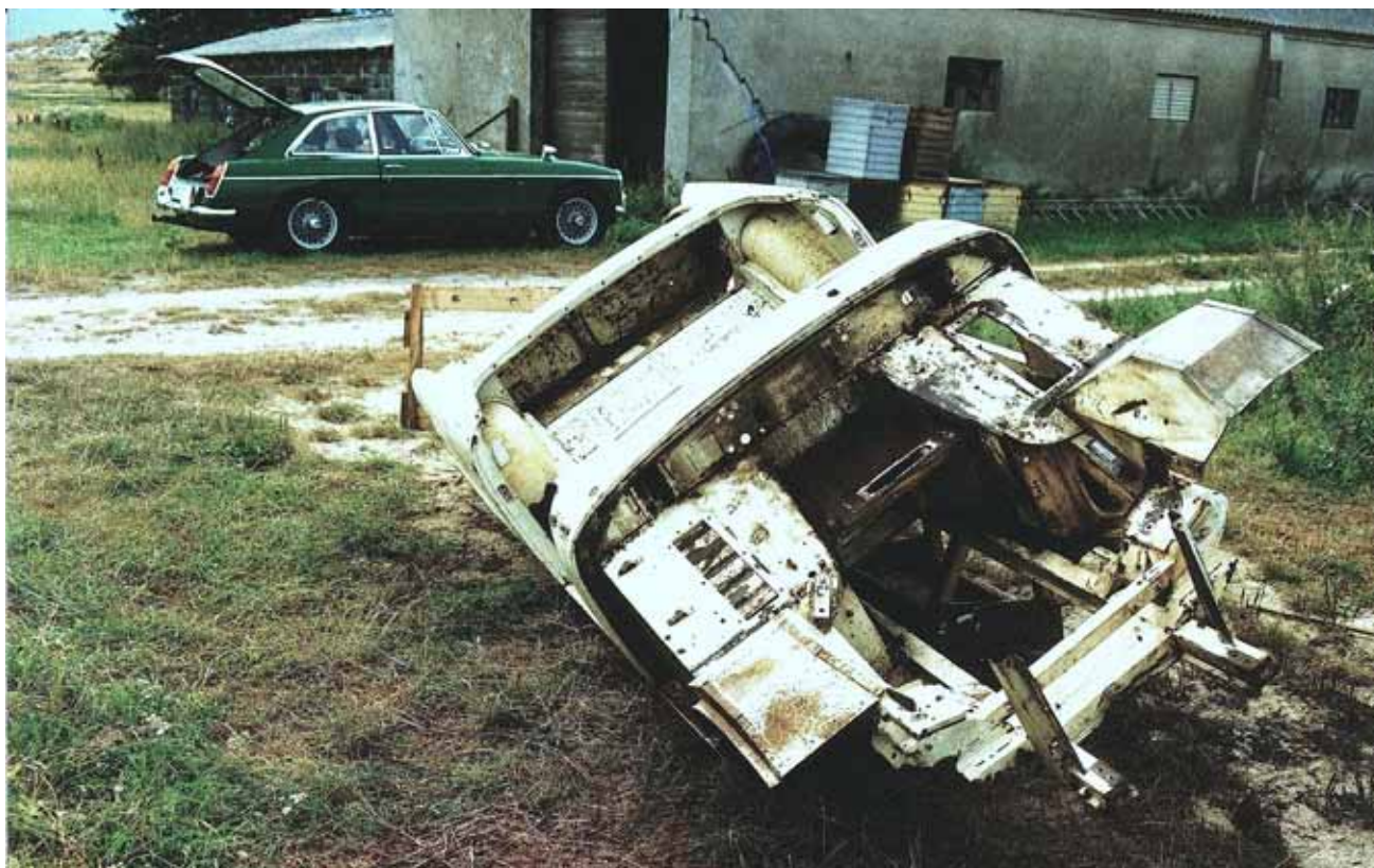
Karrossen efter højtryksrensning. Det hvide er malet stålplade, det rødprykkede er overfladerust og det sorte er asfalt - ikke så galt endda. Efterår 1997.
