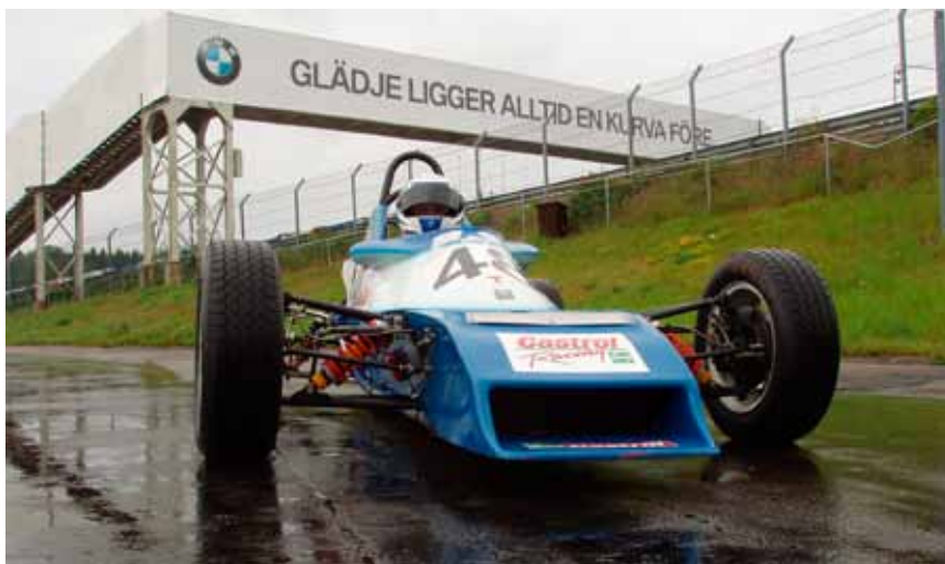
Denne Van Diemen RF84 F2000 er den nyeste og absolut mindste formelbil, jeg har kunnet klemme mig ned i, og stadig kunnet bevæge mig i - 2005! Bemærk fravær af eksterne støddæmpere og fjedre på denne model som Jesper Villumsen kørte i vrede og til DM i 1984-85 (Casper)
