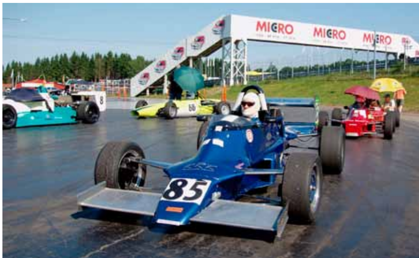
Denne Van Diemen RF84 F2000 er den nyeste og absolut mindste formelbil, jeg har kunnet klemme mig ned i, og stadig kunnet bevæge mig i - 2005! Bemærk fravær af eksterne støddæmpere og fjedre på denne model som Jesper Villumsen kørte i vrede og til DM i 1984-85 (Casper)
