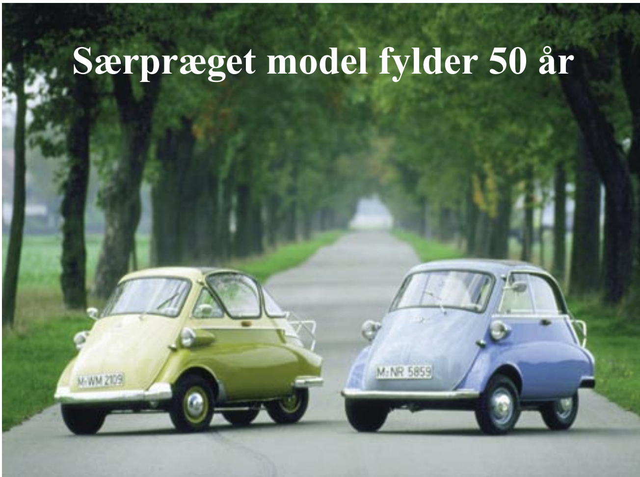
BMW Isetta blev fremstillet i to forskellige modeller, Standard (t.v.) og Export. Forskellen mellem de to modeller lå bl.a. i forskellige kofangere, sideruder, der kunne åbnes, og en bedre undervogn på Export-modellen.
