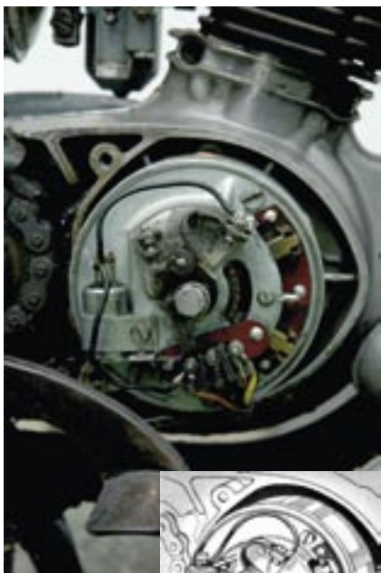
Dynamo med knikserkontakt yderst.
