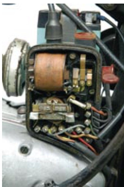
Spolekassen. Øverst til venstre ses tændspolen, derunder spændingsrelæet. Til højre ses øverst hovedkontakten, derunder sikringen. Udvendig ses nøgle og øverst den røde ladelampe. Det tykke kabel øverst i billedet er speedometerkablet der trækker på baghjulet. Akkumulatoren ses bagved.
