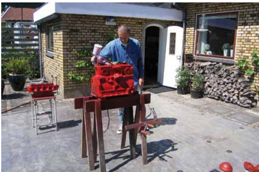
Det er blevet godt vejr og der kan lakeres i det fri. Her motorblok og topstykke.
