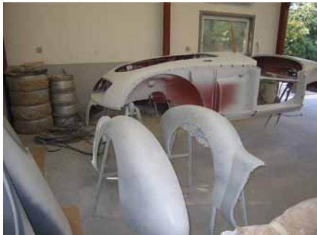
Hos autolakereren er der blevet slebet, primet, sealet, grundet og lakeret til den store guldmedalje.
