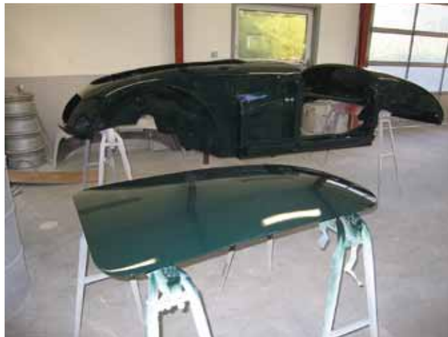
Hos autolakereren er der blevet slebet, primet, sealet, grundet og lakeret til den store guldmedalje.
