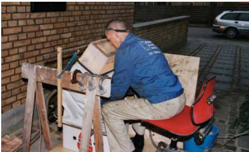
Der sandblæses. Her er det hængsler til motor- og bagerumsklap.
