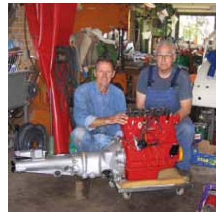
Motor og gearkasse renoveret og samlet klar til montage-
