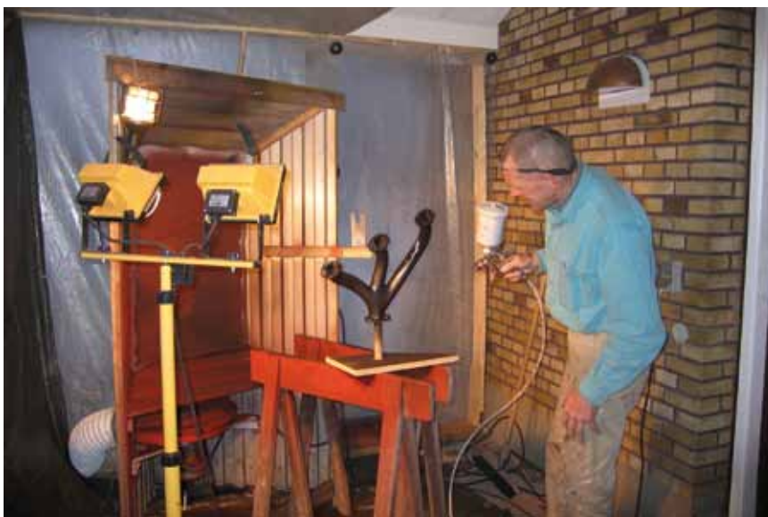
Udstødningsmanifold lakeres med varmebestandig lak.
