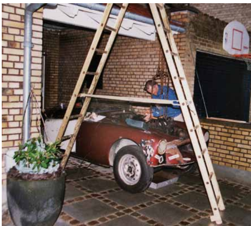
Motoren demonteres ved hjælp af stiger og diverse primitivt materiel.
