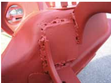
Chassisrammen totalt demonteret. Primit efter sandblæsning og lakeret. Svejsningerne ved motorophæng er ikke for gode.
