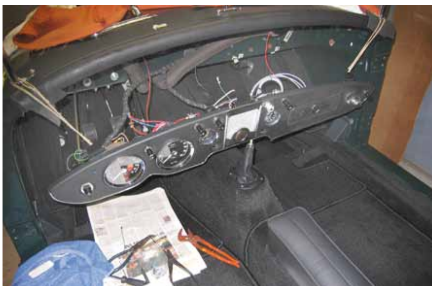
Måtter erfærdigmonteret. Nu gælder det instrumentbræt og øvrige elektriske komponenter.
