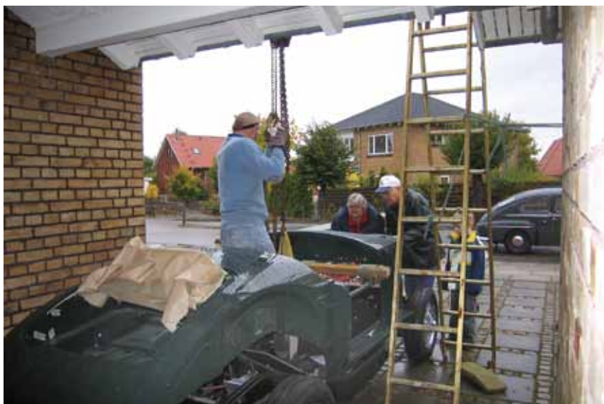
Karrosseri og chassis forenes ved hjælp af primitive hejssystemer.
