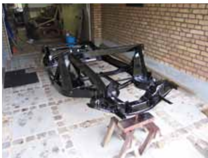
Chassisrammen totalt demonteret. Primit efter sandblæsning og lakeret. Svejsningerne ved motorophæng er ikke for gode.
