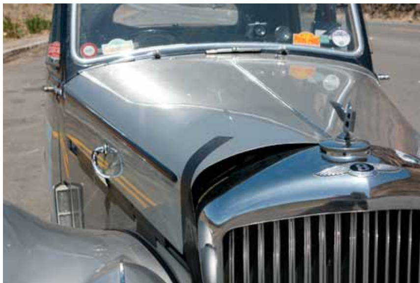
Vi modificerede kølerhjelmen lidt, således at vi fik bedre køling på karburatorerne og benzinledningerne. Det hjalp nu ikke ret meget.
