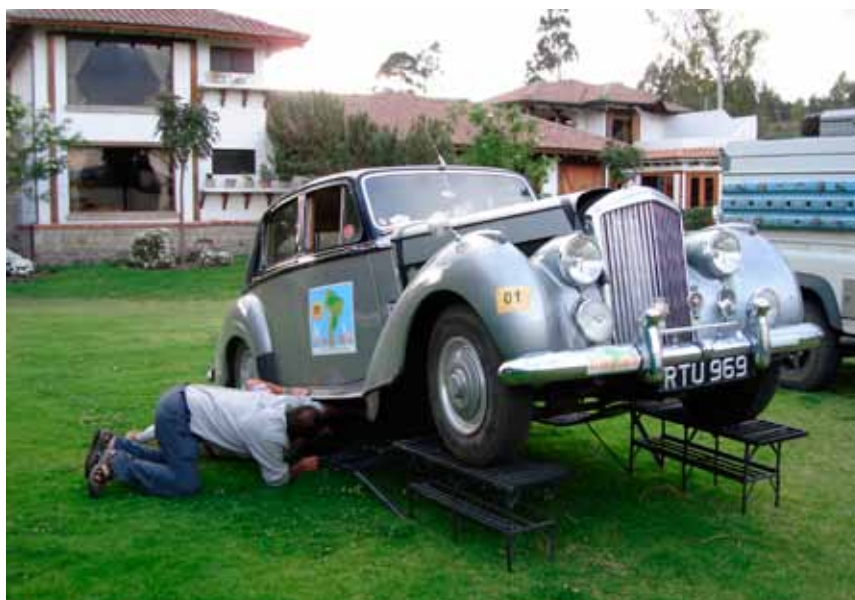
Vi skiftede den dobbeltvirkende SU benzinpumpe i Riobamba i Ecuador, og hotellet lånte os denne fantastiske rampe. Bilen kørte fint med den nye pumpe, men det løste ikke vores dampplommeproblem.
