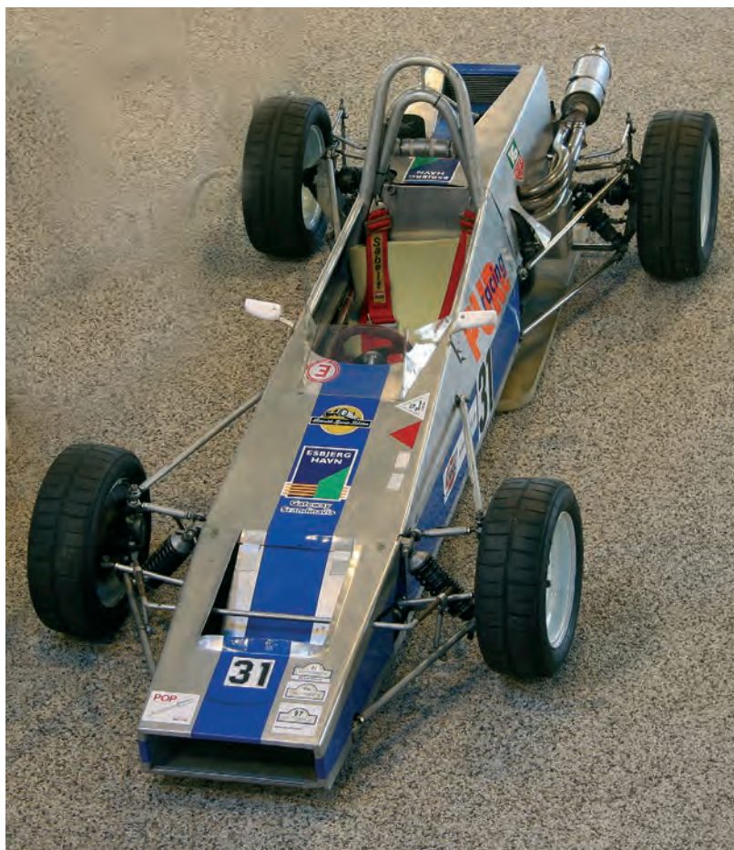
CORAMI FF Mk II, Formel Ford, årgang 1973. Konstrueret af Otto Larsen, København. Kørt i løb af Jan T. Petersen. Restaureret af nuværende ejer, Henning Bitsch, 1991-95. "Yderst hurtig, nem at tumle og styrede fantastisk". Motor Kent 1600 GT, 105 hk ved 6.000 omdrejninger. Hewland Mk 9 transmission. Vægt ca. 420 kg.
