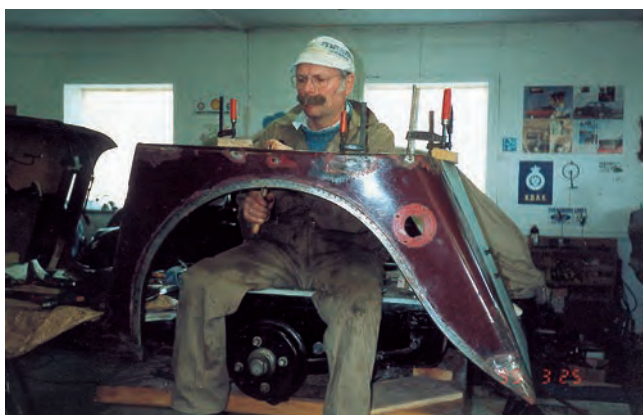
Montering af pladedele på træskelletet.
