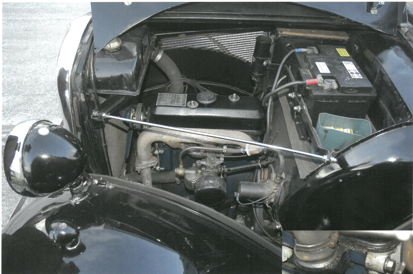
Motoren har to forkæder, en til den overliggende knastaksel og en til dynamo/strømfør- ler. Den lille forkromede fingerskrue er til at stille knastkædens spænding. — Motorrummet har ikke været støvet af mens Bent Friis har ejet vognen. Det der er, skal have lov at blive der.
