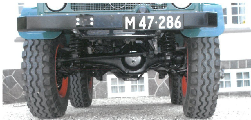
Et kig set forfra under maven på Unimog'en; her er der nok at tage vare på: razeppede på forakslens drivaksler, navreduktion, skruefjedre med teleskopstøddæmpere og en lørdag formiddag til komplet smøring og kontrol. Den sorte hætte over nummerpladen er et kraftudtag til drift af frontmonterede redskaber, såsom gadekoste, wirespil mm.
