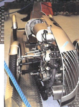
Et afsnit af udstillingen behandlede interessante småkøretøjer fra tyverne og tredverne på motorcykelbasis. Her en Neumann-Neander Fahrmaschine – bemærk centralrørschassiseet
