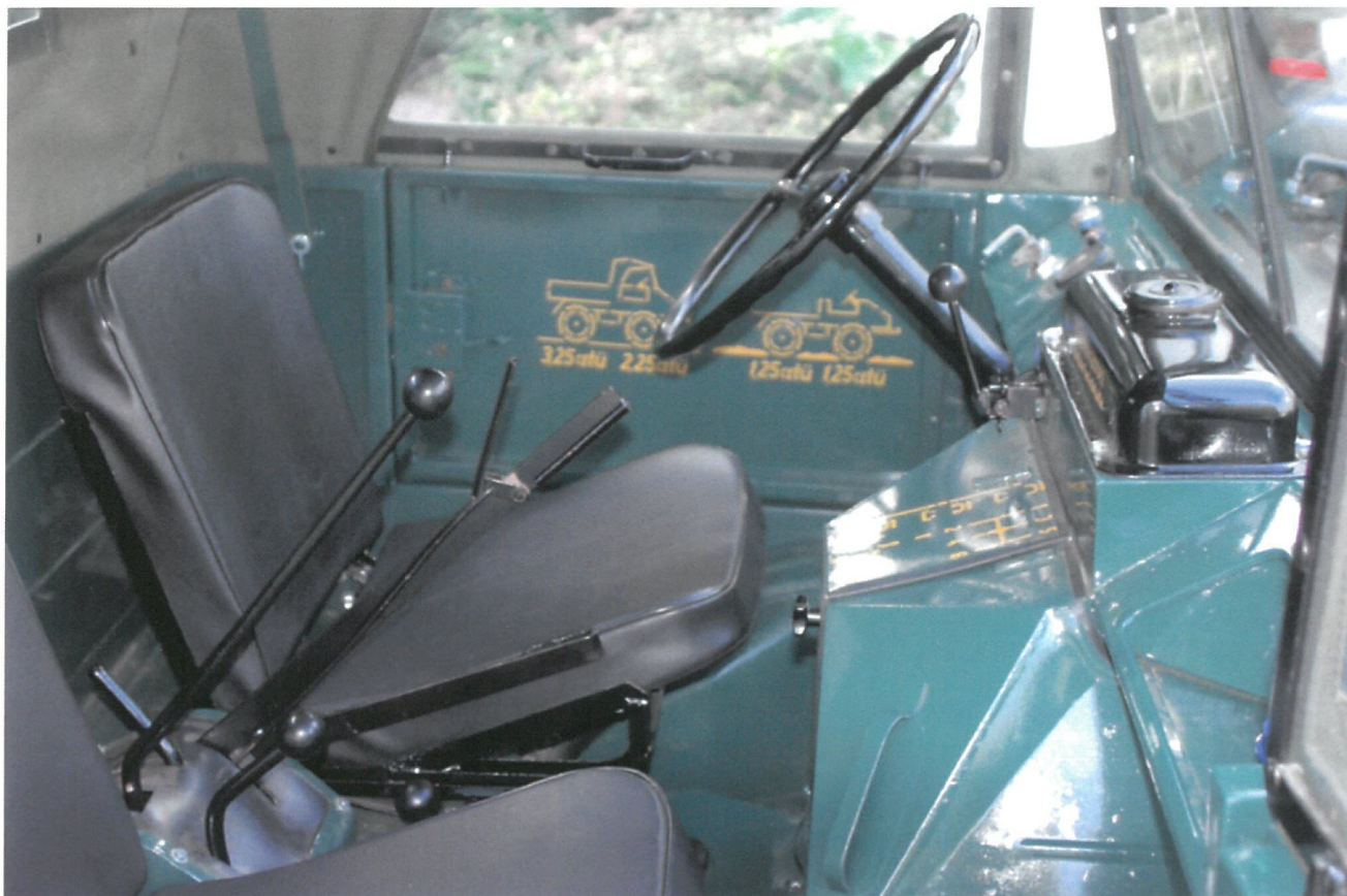
Førerpladsen; her er nok af håndgreb som en bulldozer og nok at tage vare på, bemærk kølerens topkammer er inde i førerhuset og varmer selv på en hed sommerdag. Pladsen er unægtelig noget kneben. Jørgens kompromisløst korrekte restaurering skinner tydeligt igennem.
