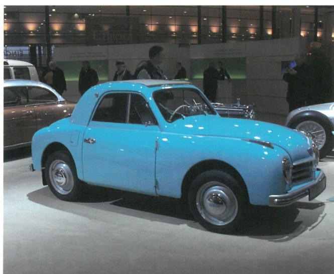
Gutbrot 1951, en småbil med interessant teknik, nemlig totaktsmotor med direkte indsprøjtning. Konstruktøren var den senere så berømte Mercedes-chefkonstruktør Hans Scherenberg.
