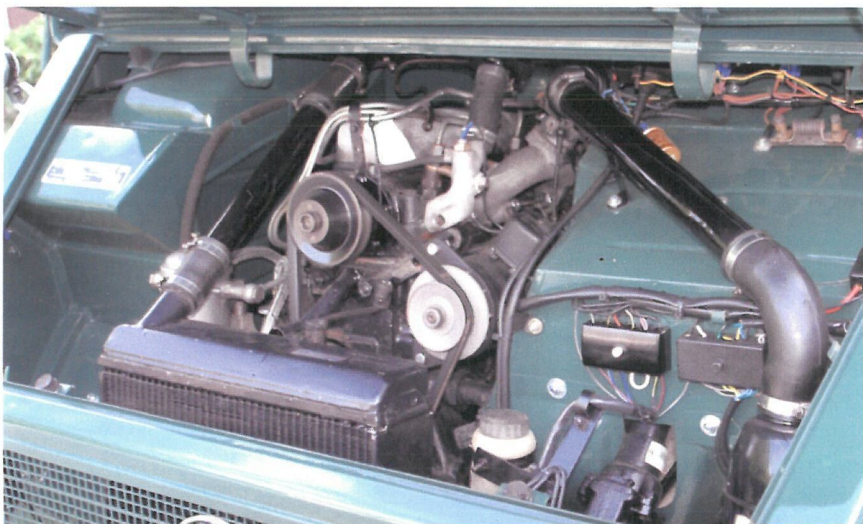
Motorrummet, pladsen er meget kneben og motoren er nærmest lempet ned med et skohorn, men en kappe kan dog fjernes inde i førerhuset for tilsyn med motoren. Udstødsmanifolden sidder på højre side lige ved passagerernes fødder og svider deres sokker!
