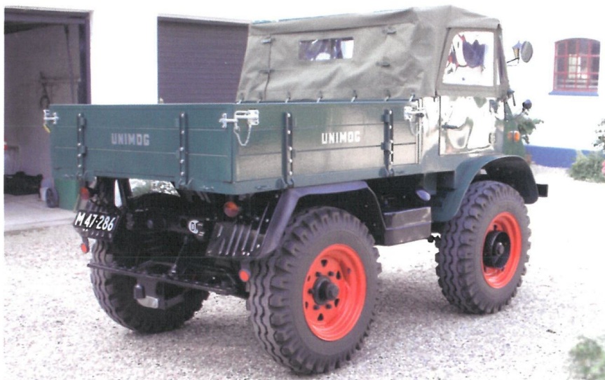
Set bagfra, oversejlet er nyt, leveret af Daimler-Benz oldtimerafdeling og er fremstillet af bomuldskanvas, helt som de altid har været det. Bemærk redskabsbommen agterst. Til montage af alskens redskaber.
