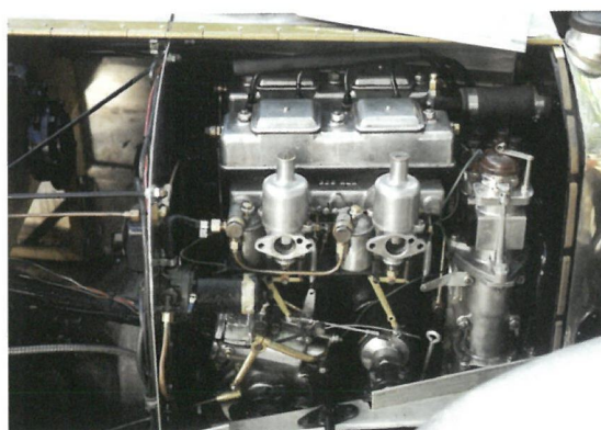
Percy Riley skabte et lille mesterværk i 1925. 4 cylindre, 1.096 cc og 60 hk ved 5.500 o/min. Det giver en topfart af næsten 160 km/t. Hvis man tør! Motoren blev udgangspunkt for den 1½-liters med kompressor der lå i den eneste britiske Formel 1-racer af betydning før krigen, ERA.
