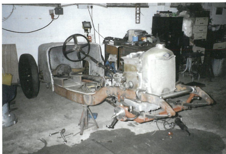
Percy Riley skabte et lille mesterværk i 1925. 4 cylindre, 1.096 cc og 60 hk ved 5.500 o/min. Det giver en topfart af næsten 160 km/t. Hvis man tør! Motoren blev udgangspunkt for den 1½-liters med kompressor der lå i den eneste britiske Formel 1-racer af betydning før krigen, ERA.
