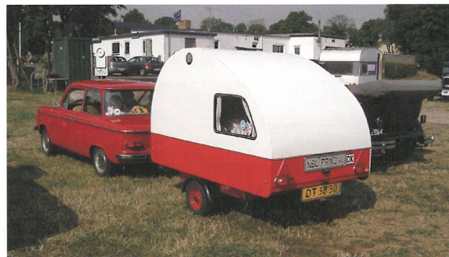
Og trods sine kun 600 cc kan den fortræffelige motor i en Prinz – med overliggende knastaksel, drevet af skubbestænger gennem ekscentrikker - slæbe en let campingvogn. Prinz 4 var for øvrigt også godkendt til at bære sin egen vægt som nyttelast.
