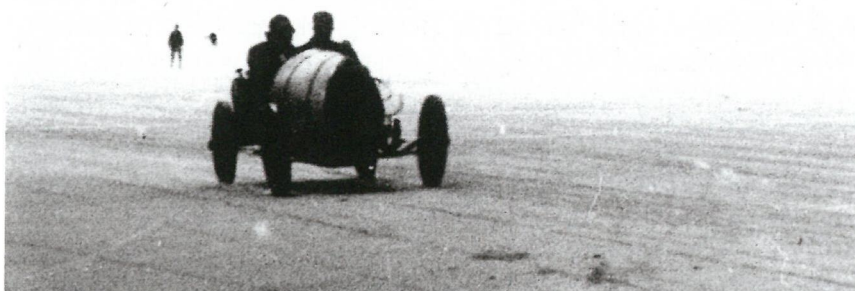
Bugatti Brescia 'en første gang på Fanø Strand 1922 - let genkendelig med den kraftige positive camber på forhjulene og benzintønden bag førersædet.
