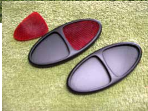
Øverst ses det 3D-printede emne med de tilpassede reflekser, og her til venstre som det ser ud efter slibning og mailing.
