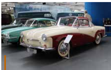
Rometsch Lawrens Coupe, årgang 1959 Modellen er særdeles sjælden og bygget i ganske få eksemplarer. Den kunne fås h.v. som Cabriolet og Coupe. Motoren er en 4 cylindret 1.192 cm 3 boxermotor på 30 HK, tophastighed 110 km/t.
