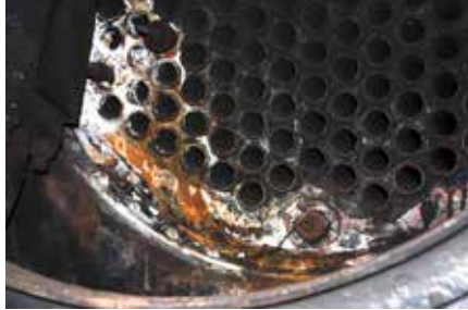
F658 Frichs damplokomotiv fra 1950 og de tærede kedelrør
