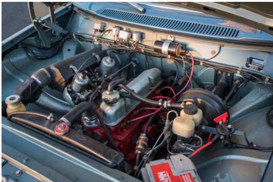
Volvos B20B motor med dobbelte SU karburatorer
