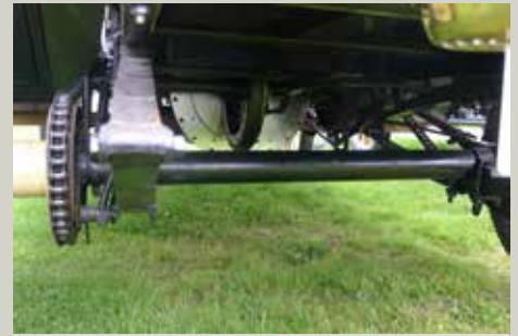
Metz 1914 er lidt for sig selv: helelliptiske fjedre og milliongear med kædetræk. Den kørtes af Stein Tronsli og det våde vejr lørdag voldte tilsyneladende ikke problemer for transmissionen.
