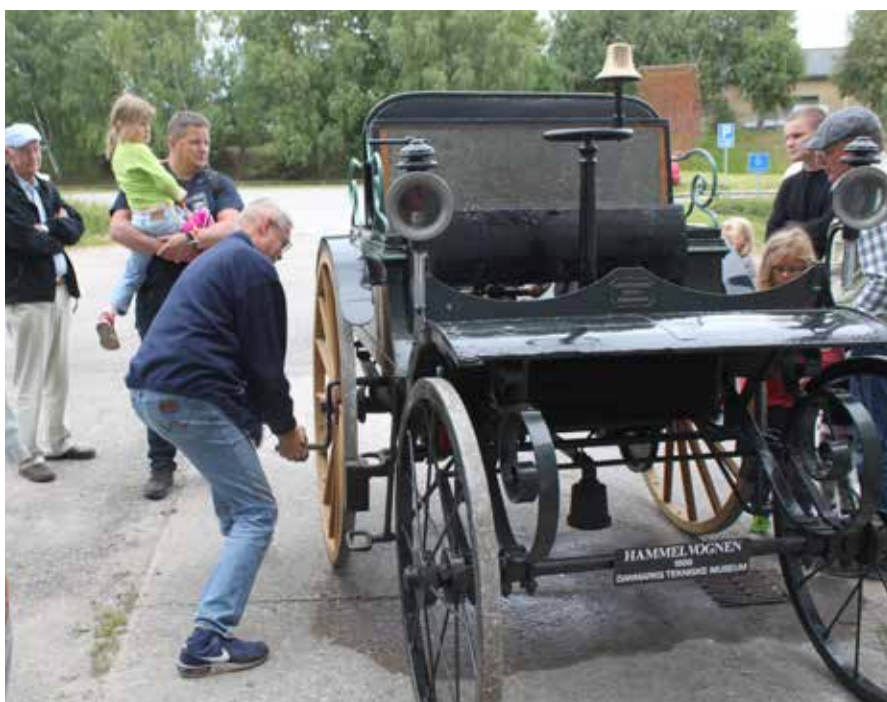
Øverst ses Mikkel Posselt ved rattet, der virker modsat; skal man til højre drejes det til venstre. Herover har Per Nielsen sat håndsvinget i – motoren startes gennem baghjulet!
