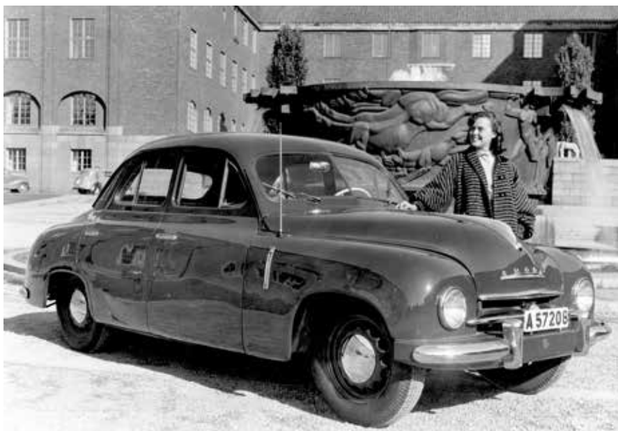
Škoda 1200/1201 var den første rigtige efterkrigsmodel – ganske moderne med sit pontonkarrosseri. Den blev introduceret i 1952 og lavet i en mængde karrosserivarianter; stationcar, ambulance, varebil og pickup. Den holdt sig i produktion til 1957.
