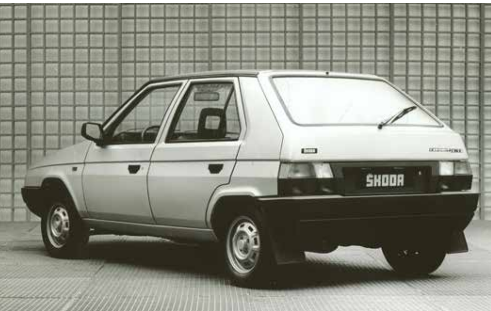
Škoda Favorit var den sidste selvstændigt udviklede Škoda, men den første med frontmotor og forhjulstræk. Den holdt sig i produktion fra 1987 til 1995.
