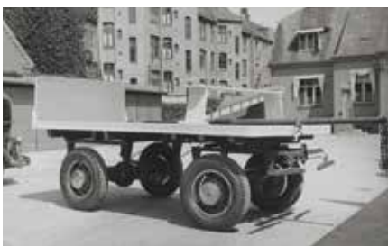
Besættelsen betød tilbagegang fra motor- til rigtige hestekræfter. SMC ombyggede således biler til hestevogne. Billeder fra Nygaardsvej, København Ø.
