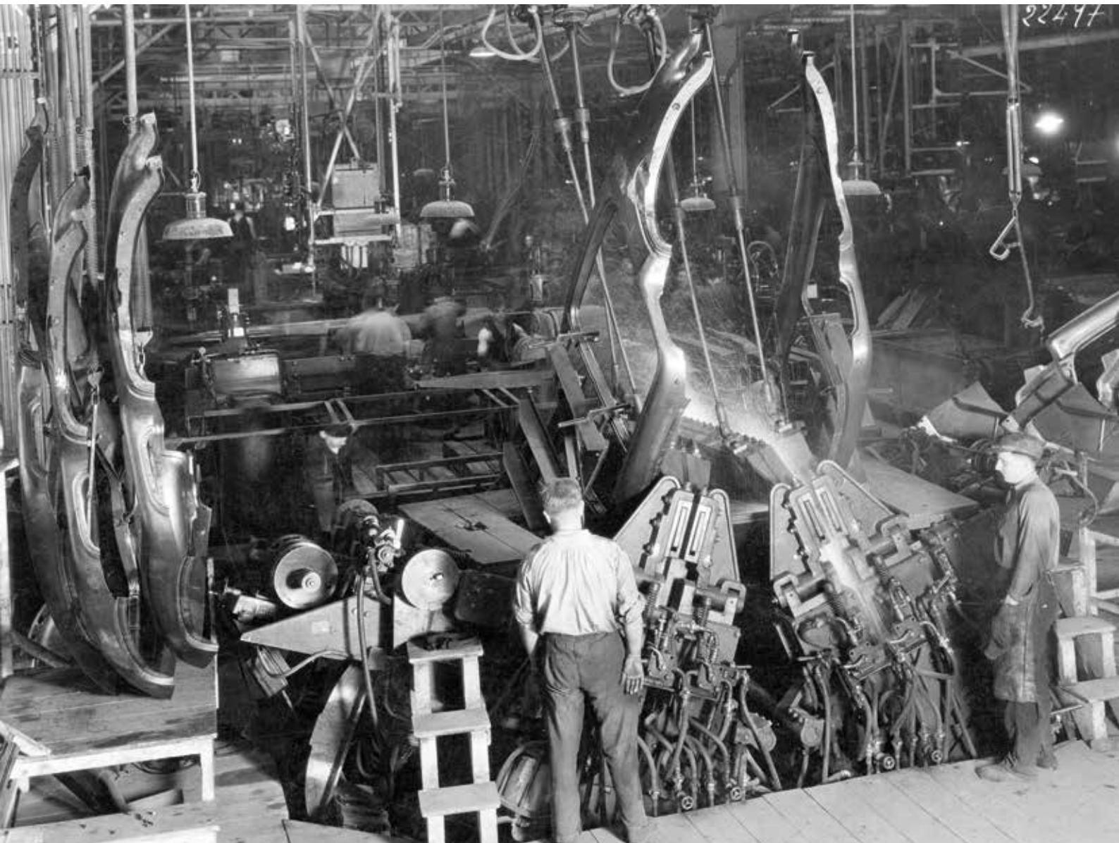
De to karrosserisider svejses sammen med bagendens yderside i dette anlæg, som må have været det ypperste højteknologiske på sin tid. Et godt eksempel på hvor industrialiseret produktionen af Citroën 7 var fra dag 1. Billedet er taget i 1934!
