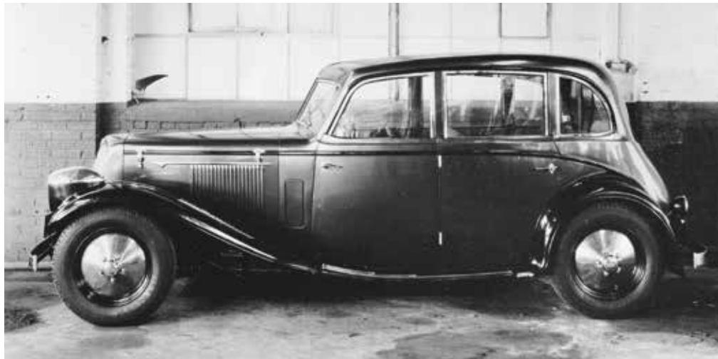
Joseph Ledwinkas prototype havde både forhjulstræk og selv bærende karrosseri i 1931. På dette tidspunkt havde André Citroën givetvis i flere år med stor interesse været mere eller mindre involveret i Budds udviklingsarbejde. Foto fra Per Åhlström.
