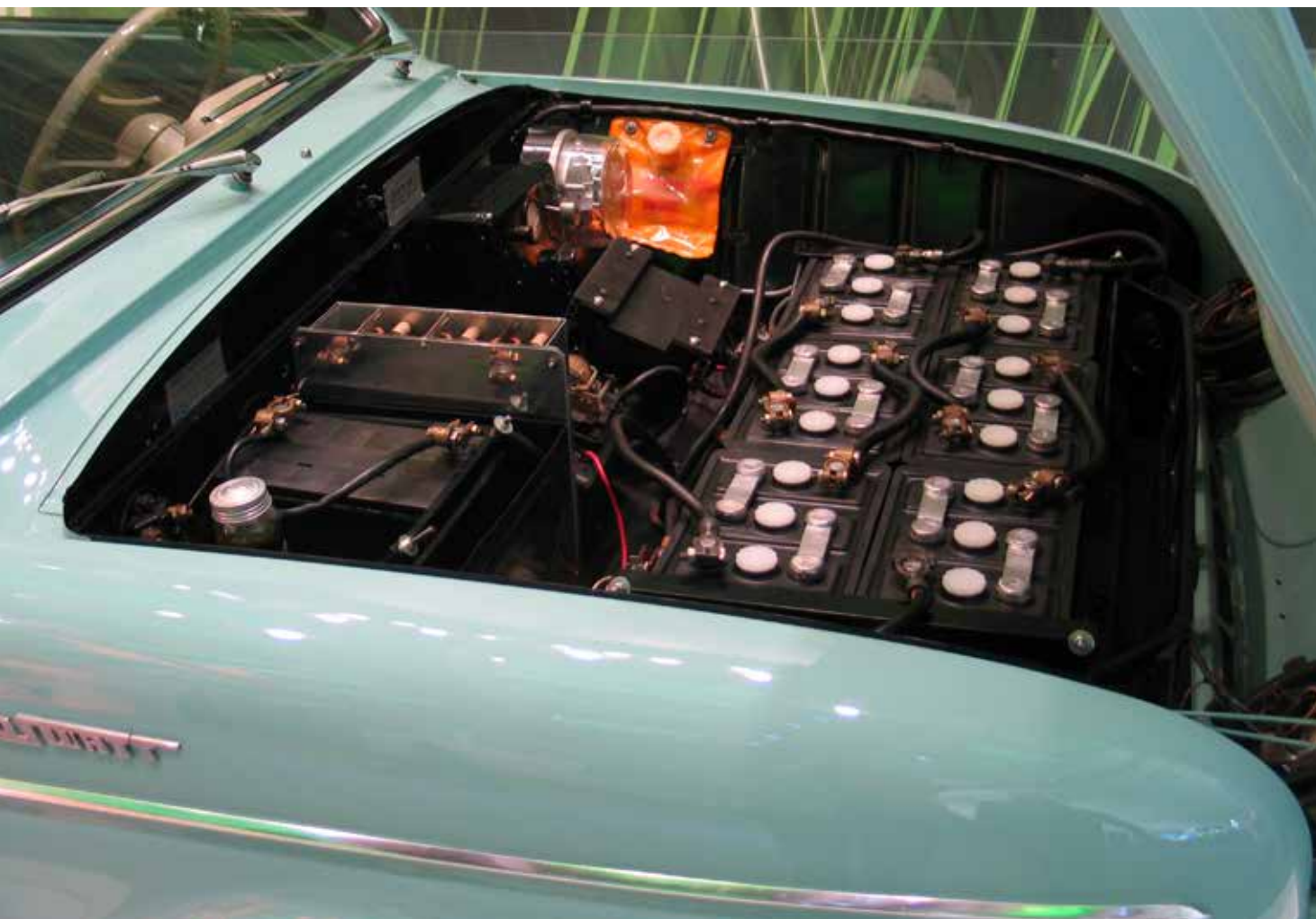
Henney Kilowatt årgang 1960 havde 12 stk. 6V-batterier – her ses halvdelen af dem. Egenvægten af bilen var ca. 970 kg.
