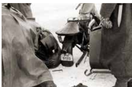
Tilsyneladende har de tyske politisoldater ikke været klar over, hvor genial en Nimbus egentlig er. Var sidevognscyklens blev rejst op på stativbenet, var baghjulet kommet til at svæve frit, og så kunne man helt uden anstrengelse have afmonteret det.
