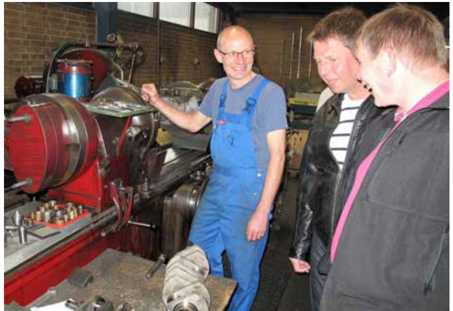
Mange specialmaskiner – her krumtapaksel under bearbejdning
