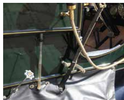
Vandstanden i tanken kan ses gennem det lille glasrør – på den modsatte side af bilen.
