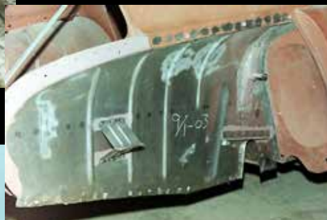
Højre inderskærm bagi – den gamle og den nye...
