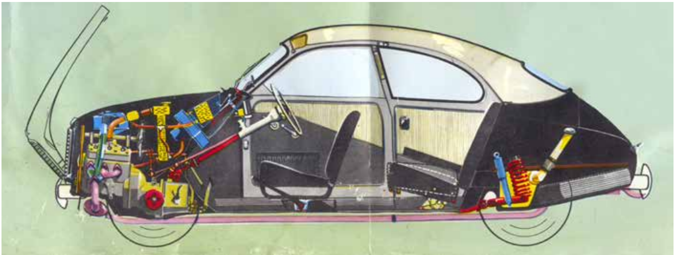
Røntgentegning fra en brochure for Saab 93B, 1958. 3-cylindret motor på langs, skruefjedre, udvendigt bagagerum og en mere sikker placering af benzintanken længere inde under vognen. I samme brochure ses både hans og hendes Saab – det er flygkvalitet!
