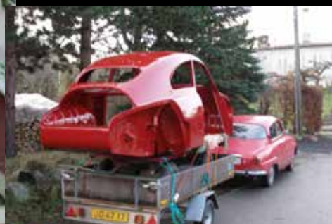
Ny lak og klar til montering!
