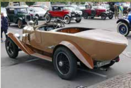
1924 Voisin C5 med Belvalette karosseri - en svensksolgt bil, som blev restaureret af Curt Borgenstam og sammen med hans andre biler og motorcykler testamenteret til Bertil Lindblads Stiftelse. Vognen har en 4-cylindret 4 liters glidermotor med 95hk og en topfart på 125km/t. Alt-i-alt et imponerende køretøj. Glidermotoren giver en nydelig røgfane når der sættes igang. Per Nielsen, som vist må være eneste danske Voisinist, fik en rundtur og var et stort smil, da den var overstået.
