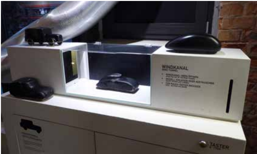
Vindtunnel, hvor man med røg kan se luftstrømmen over forskellige karrosserier
