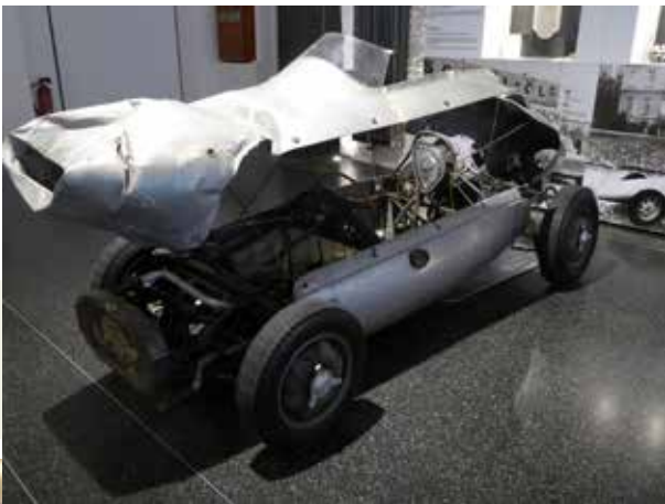
Von Trips junior racer fra 1959 med 3 cyl.DKW-motor. Denne vogn forulykkede på Nürburgring 1961 og blev aldrig genopbygget
