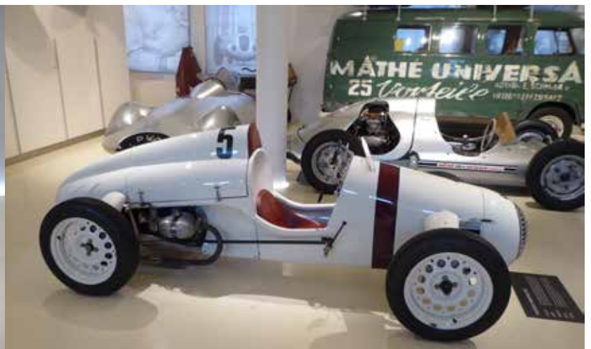
Polensky Monoiletta 1950. 500 ccm BMW motorcykelmotor. 265 kg, 188 km/t.
