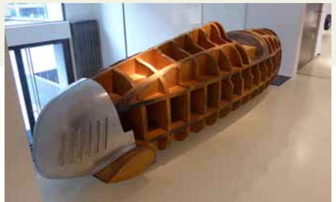
Træform for karosseri til Auto Union typ C 1936/37. Over denne form udbankedede man aluplader i 0,6-0,8 mm.
