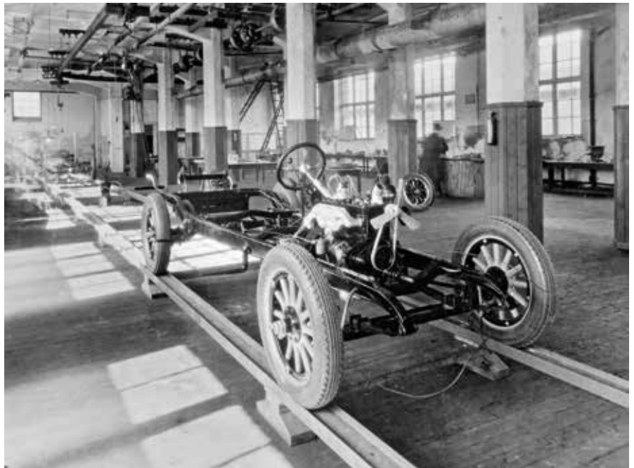
Undervogn med monteret motor på fabrikken i Lundby.
