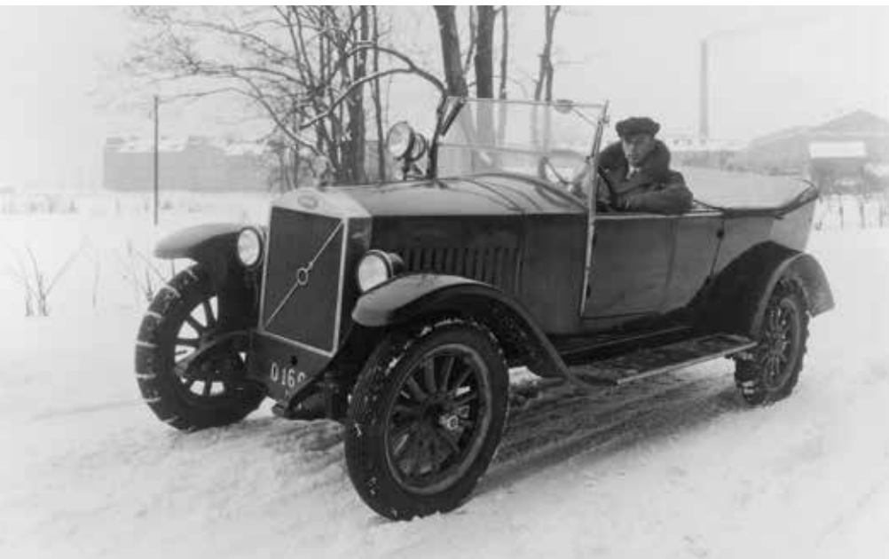
Prøvekørsel med Volvo ÖV4 i sne. Bemærk påmonterede snekæder på både for- og baghjul.
