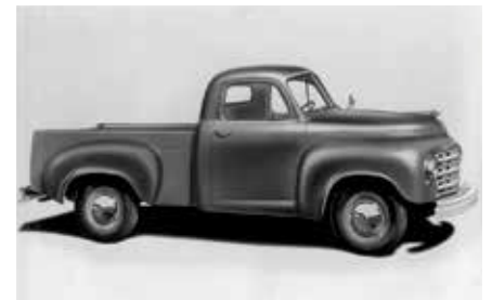
Studebaker 2R10-pick-up. På grund af valuta-restriktioner en sjælden fugl i Danmark, men den har i dag kultstatus i USA. En af grundene er, at den blev bygget på sit eget chassis og ikke på et personvognschassis, som ellers var almindeligt på det tidspunkt (1949).
