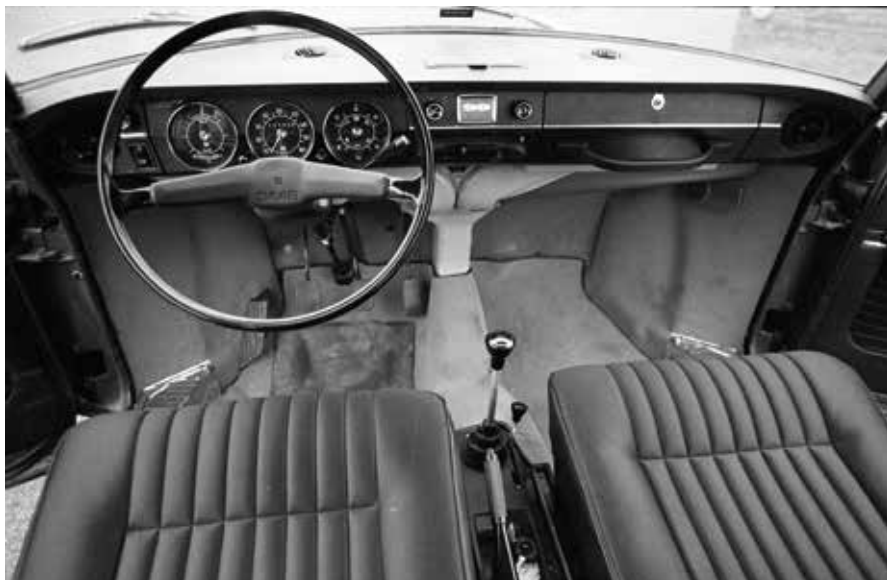
Førerpladsen i den første udgave. Det lille håndtag til højre for gearstangen bruges til at koble friløbet til og fra – et "levn" fra 96-modellerne.
