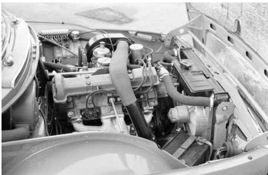
Den skrånende Triumph-motor med knastakseldækslet på toppen.
