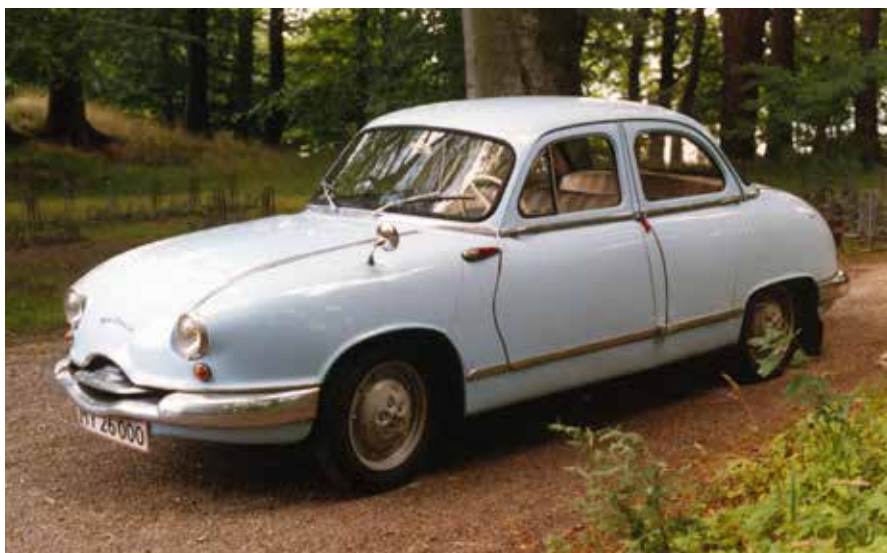
De rød/hvide fabriksmonterede blinklygter på denne Panhard Dyna 1957 kunne ikke godkendes af den danske myndigheder. De måtte suppleres med et par ungpigebryster foran og et par smalle badekar på B-stolperne. Modellen er typegodkendt med hele 8 blinklys!
