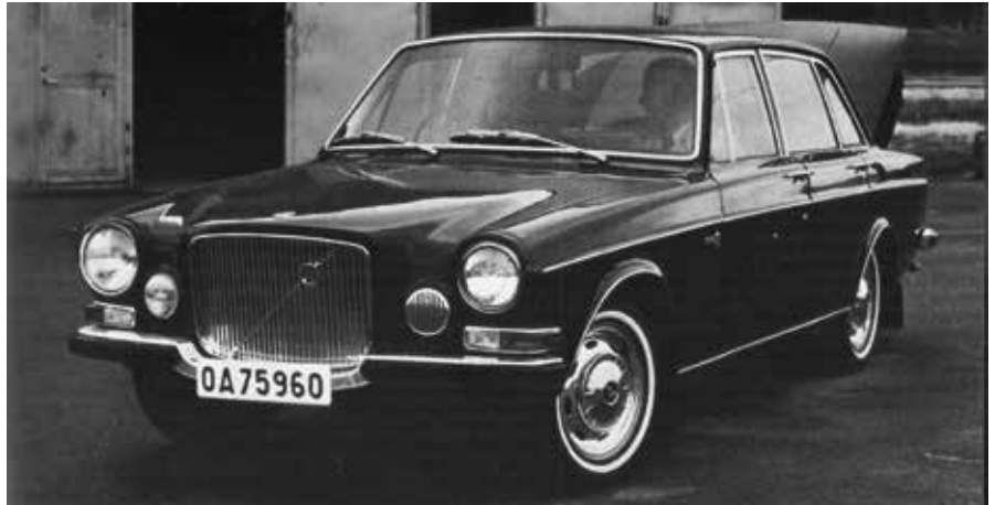
Volvo 164 prototype. Bemærk at bilen i højre side er udstyret med en tågelygte, hvorimod den i venstre side har et lille rundt gitter. Logoet og den diagonale kølerstribe er en integreret enhed forskellig fra den endelige produktionsløsning.
