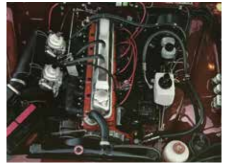
Volvo 164's motorrum i årgang 1969. Til venstre ses B30 motorens dobbelte Zenith-Stromberg karburatorer.
