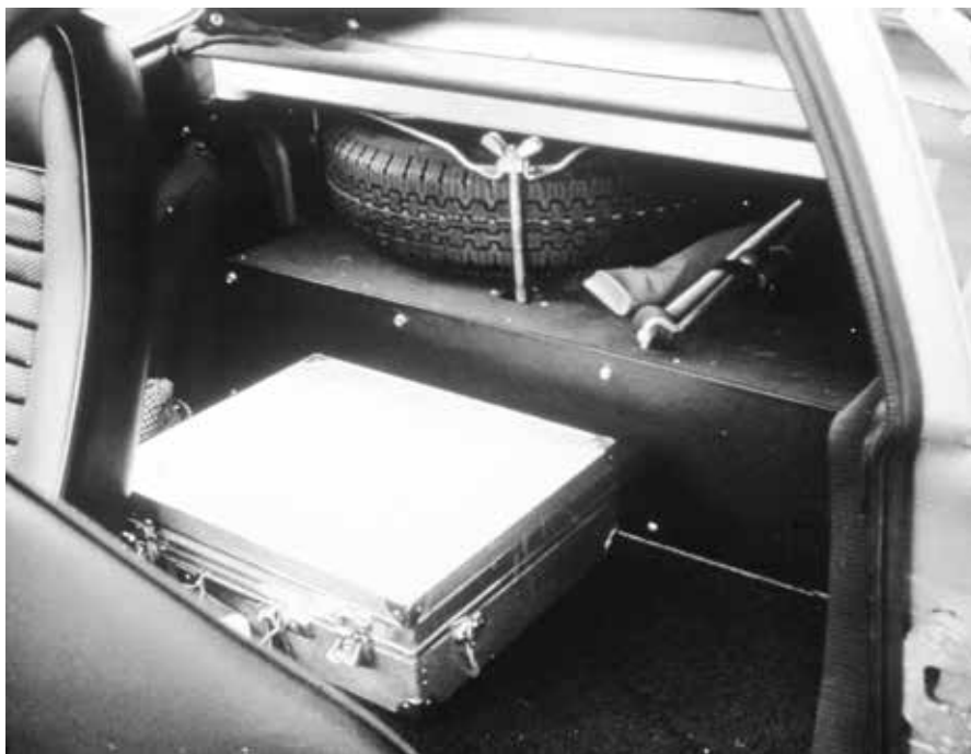
Reservehjulet ligger inde i kabinen, under bagruden. Den minimale bagageplads bag sæderne anskueliggøres med en fotokuffert. Der er ingen bagklap, kun adgang til reservehjul og bagage gennem de to døre.
